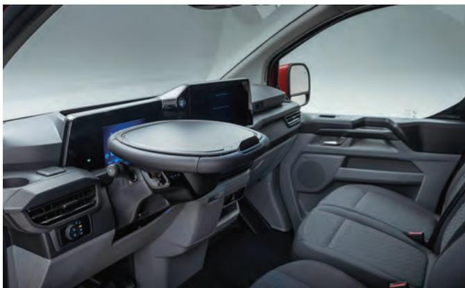
图13 创新的转向盘倾斜功能可以让驾驶员在停车时创造一个倾斜的桌子，适合放置笔记本电脑或吃午餐
