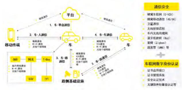
图9 车联网终端与设施网络安全
